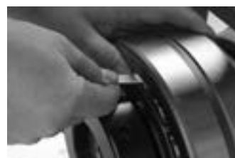
Mida el RIC antes de la instalación.
