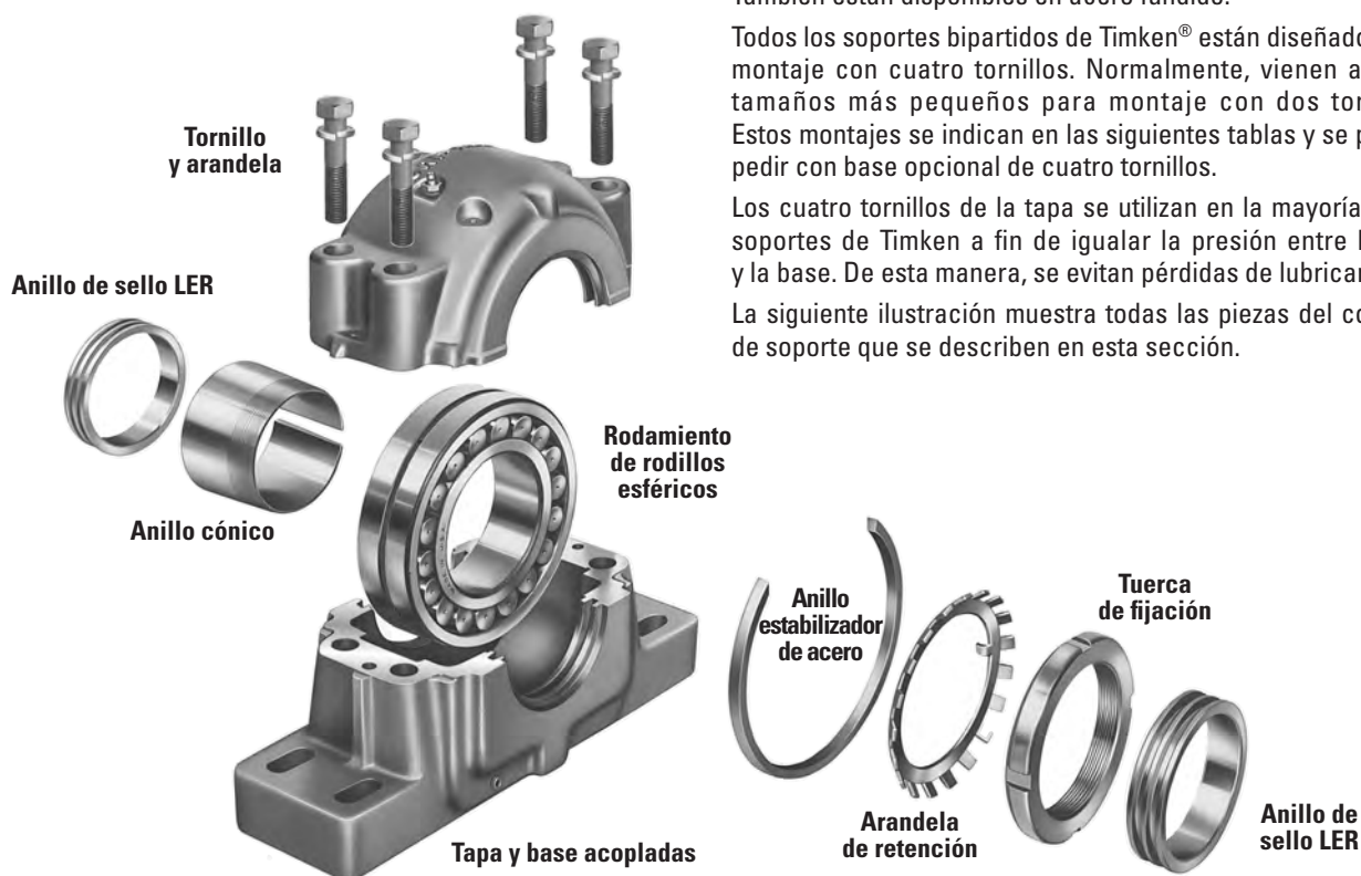
Fig. 26. Vista de despiece de un soporte de rodamientos de rodillos esféricos de Timken en el que se muestra el rodamiento de rodillos esféricos de diámetro interior cónico, el manguito adaptador, la tuerca de fijación y la arandela de retención, el anillo estabilizador y los sellos de laberinto con triple anillo. En la base y la tapa, también se muestran los huecos que forman la ranura para apalancar herramientas y los salientes integrales del fulcro.
