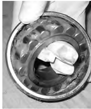
Fig. 21. La grasa puede ser fácilmente aplicada con la mano.
