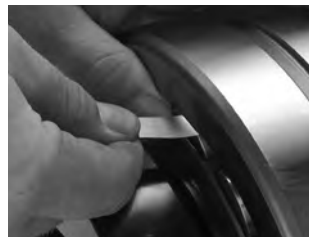
Fig. 14. Medida del RIC antes de la instalación.
