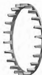
Fig. 9. Jaula guiada dividida de latón maquinado y tipo saliente.
