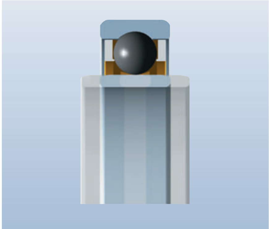
6: Durante el servicio, los rodamientos FD permiten un gran desplazamiento no forzado entre el aro interior y el exterior
